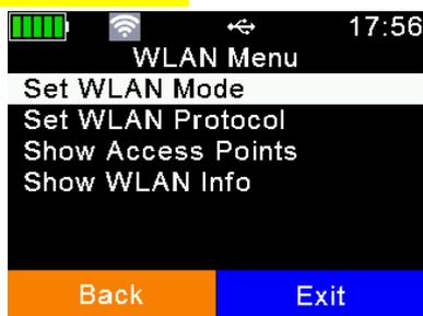
Les paramètres WLAN disponibles sur l'appareil lui-même ne sont que des paramètres de base. L'affichage de tous les paramètres possibles rendrait le menu trop complexe, c'est pourquoi les paramètres avancés ne sont configurables que par logiciel, par exemple via Senselink.
