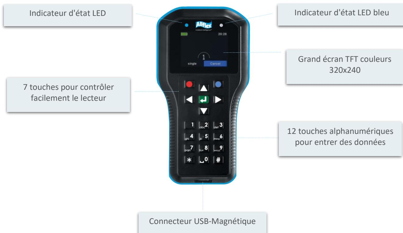
L'APR650 utilise une batterie lithium-ion 3.7V d'une capacité de 3.400mAh, située dans l'outil. Elle ne peut pas être remplacée sur le terrain. Seul le personnel technique autorisé peut changer la batterie, si celle-ci est arrivée en fin de vie.
