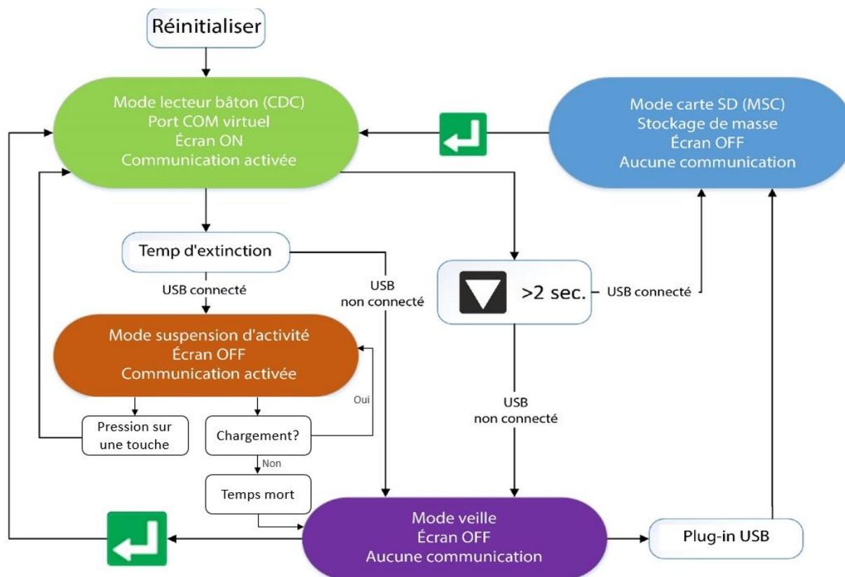
Lorsque le lecteur est allumé et qu'il est connecté par USB, il fonctionne en mode Communications Device Class (CDC). Cela signifie qu'un port COM virtuel est créé sur l'ordinateur et qu'il est possible d'envoyer des commandes à l'appareil via un port série. Dans cette situation, le mode de stockage de masse n'est pas activé et les fichiers ne peuvent pas être copiés vers ou depuis l'APR650.
