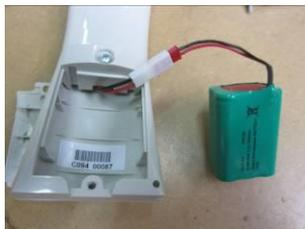
**2 Brancher la batterie sur le connecteur**
