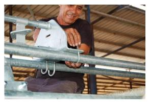
5. Coloque el pistón en el pivote de la parte posterior de la estructura.
