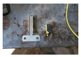
4. Fije los sensores fotoeléctricos como se indica, en la parte inferior de los tubos, luego de fijar los tubos a la estructura del portón de clasificación.
