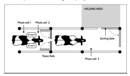
4. El pistón tiene un interruptor con sensor magnético (interruptor de fin de carrera) que le indica al sistema cuándo se cerró por completo el portón de clasificación. Solamente cuando el portón de clasificación esté cerrado por completo se abre la tranquera para permitir el pasaje de la siguiente vaca.
