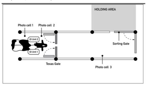
2. La vaca pasa a través de la tranquera y se activa el segundo sensor fotoeléctrico. Si esta vaca debe separarse, entonces la tranquera se cerrará inmediatamente después de su paso. Hay un interruptor magnético (interruptor de fin de carrera) en el pistón que le indica al sistema cuándo la tranquera está cerrada por completo. La tranquera continuará este ciclo de apertura y cierre hasta que el interruptor con sensor magnético indique que se cerró por completo.
