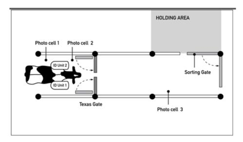
6. El sensor fotoeléctrico número 2 se debe instalar en el tubo 2. Este sensor debe apuntar al interior de la manga de la misma forma que los sensores fotoeléctricos 1 y 3. Este sensor fotoeléctrico se debe colocar a mayor altura, a 120 cm, que los otros dos sensores.
